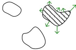
On a une pression électrostatique qui s'exerce sur le conducteur, qui n'est pas forcément nulle.
