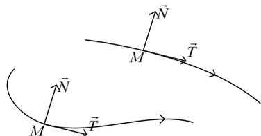
$\frac{d\vec{T}}{ds} = \gamma \cdot \vec{N}$ . Or,  $\frac{d\vec{T}}{ds}$  est l'accélération pour le paramétrage avec  $s$ . Il doit donc être dirigé dans la concavité de la courbe.
