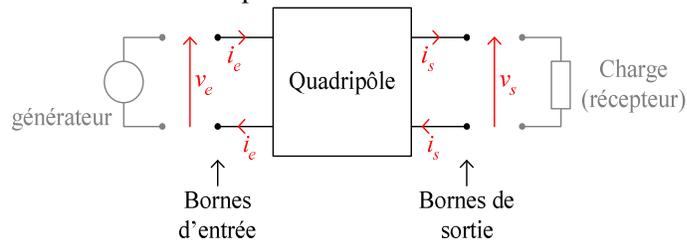
Quadripôle passif : pas de source auxiliaire de puissance électrique.
