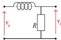
$$\underline{H}(j\omega) = \frac{R}{R + j\omega L} = \frac{1}{1 + j\omega / \omega_0}, \text{ avec } \omega_0 = \frac{R}{L}.$$
