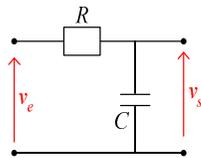
$$\underline{H}(j\omega) = \frac{1}{1 + jRC\omega} = \frac{1}{1 + j\omega / \omega_0}, \text{ avec } \omega_0 = \frac{1}{RC}.$$
