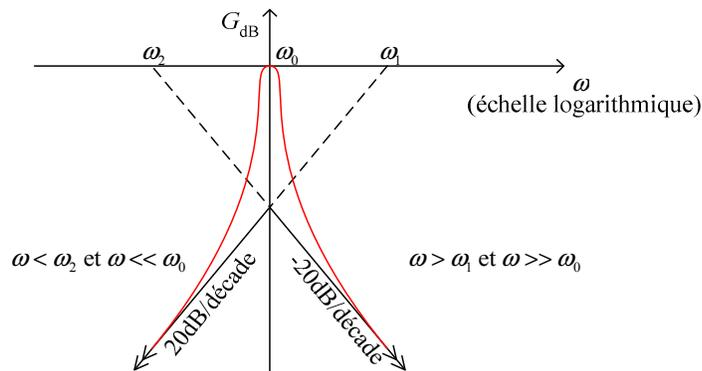
Le gain est maximum quand  $\omega = \omega_0$ ,  $G(\omega_0) = 1$ . On a un filtre passe bande (très sélectif : la bande est très petite)
