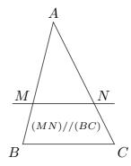
Propriété de Thalès : Dans un triangle ABC, si M est un point du côté [AB], N est un point du côté [AC], et si les droites (MN) et (BC) sont parallèles, alors les longueurs des côtés de AMN sont proportionnelles aux longueurs des
