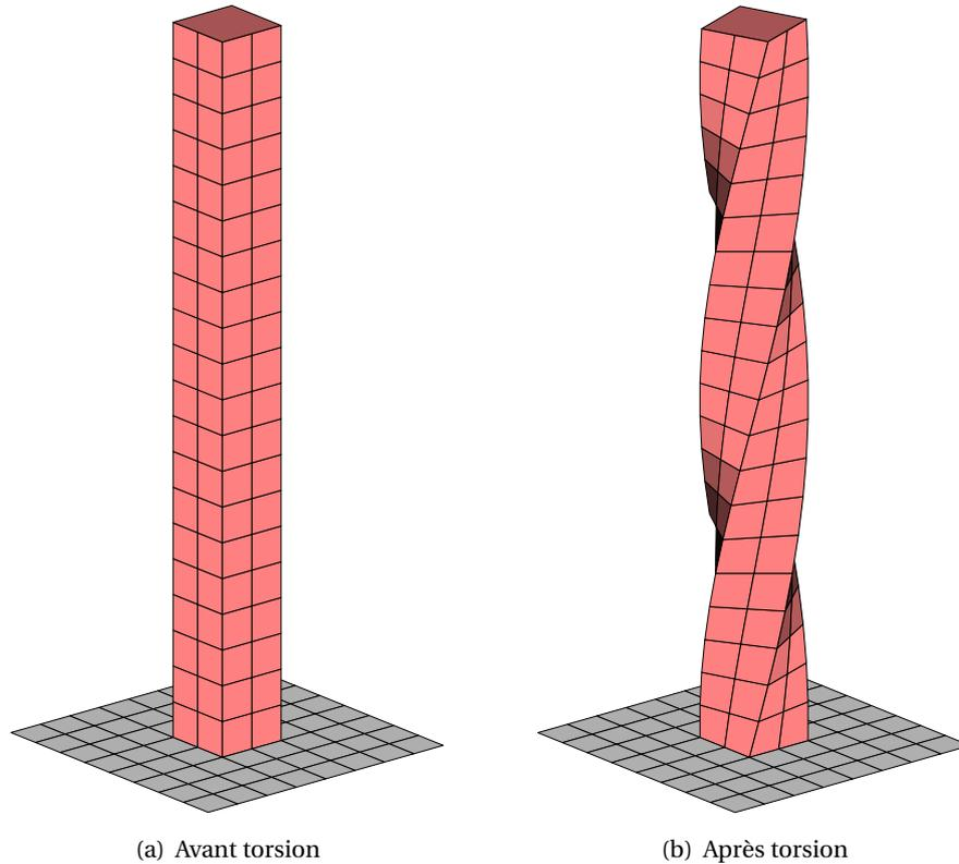
FIGURE 3.9 – Torsion d'une poutre
