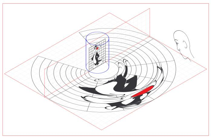
La position du spectateur est déterminée par les paramètres \psset{Yv=-20,Xv=0,Zv=15}. On pourra placer l'œil de l'observateur dans le schéma avec les commandes suivantes :
