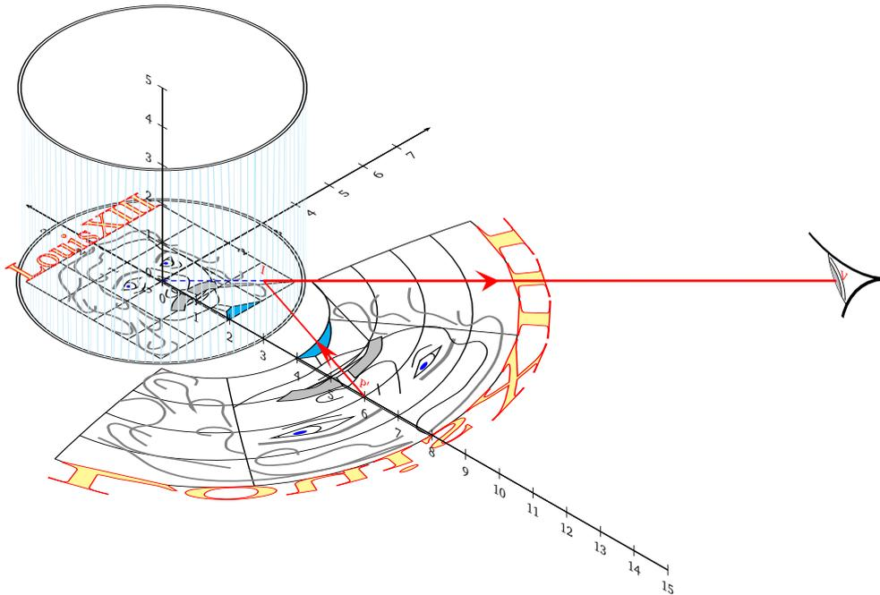
L'image non déformée (celle qui est vue dans le miroir) est placée, dans cet exemple, au centre du miroir. Un rayon incident partant de l'objet anamorphique se réfléchit sur le miroir et après réflexion parvient à l'œil de notre observateur. L'observateur a l'illusion que le rayon provient du point image. Il faut donc reconstruire mathématiquement la marche d'un tel rayon lumineux en partant de l'image dans le miroir.
