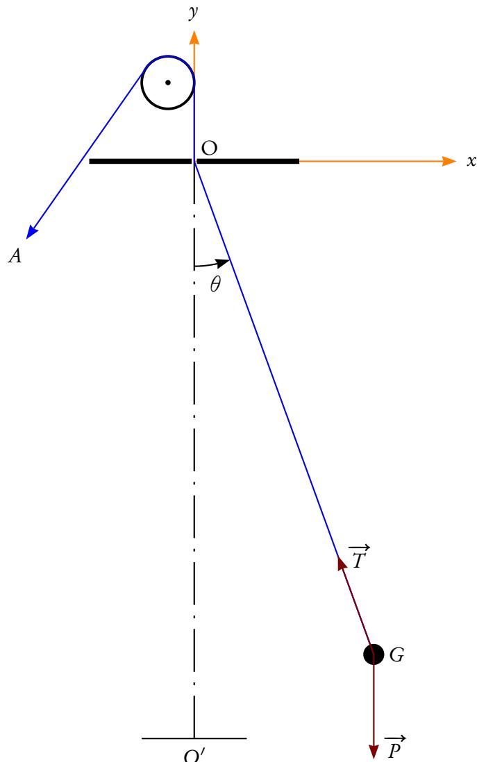
$O'$  est le point le plus bas,  $OO' = l_0$  est la longueur initiale de la corde. La longueur de la corde, inextensible et de masse négligeable, à un instant  $t$  est notée  $l$  et la charge est supposée ponctuelle.
