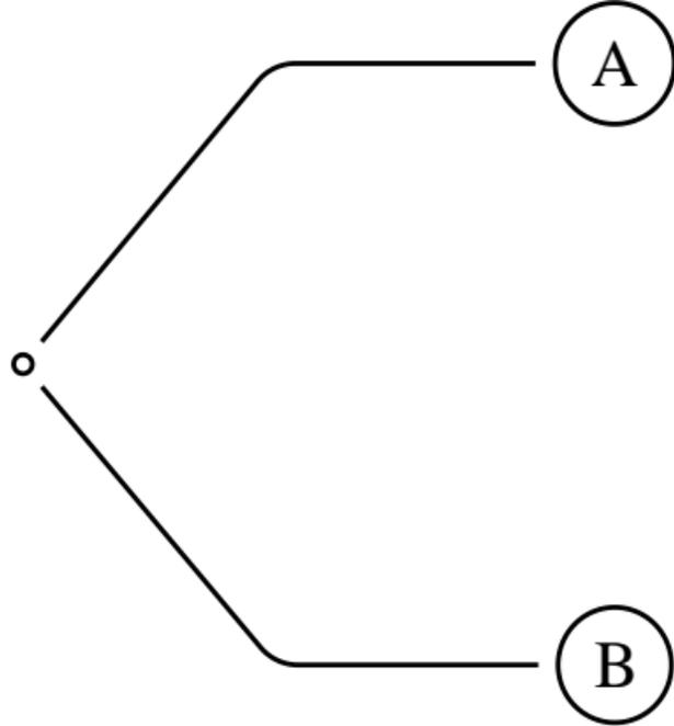
La commande **ncdiag** trace d'abord, en  $A$  et à l'angle  $angleA$ , le bras de longueur  $armA$ . Ensuite, ce bras est directement connecté au point  $B$ . Le paramètre  $linearc$  est utilisé pour arrondir les angles.
