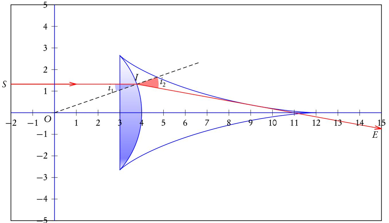
Déterminons l'équation cartésienne ( $\Delta$ ) du rayon émergent de la lentille. Le paramètre en jeu est l'angle d'incidence  $i_1$  compris entre 0 et l'angle limite  $\lambda = \arcsin \frac{1}{n}$ . On se sert, bien sûr, de la relation de Descartes :  $n \sin i_1 = \sin i_2$  pour obtenir  $i_2$  puis  $\beta = i_1 - i_2$  la pente du rayon émergent.
