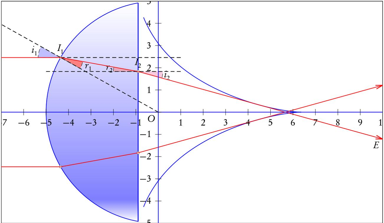
La lentille est définie par son rayon  $R$  et son épaisseur au centre  $e$  et son indice moyen  $n$ . Calculons l'angle de réfraction  $r_1$  dans la lentille :
