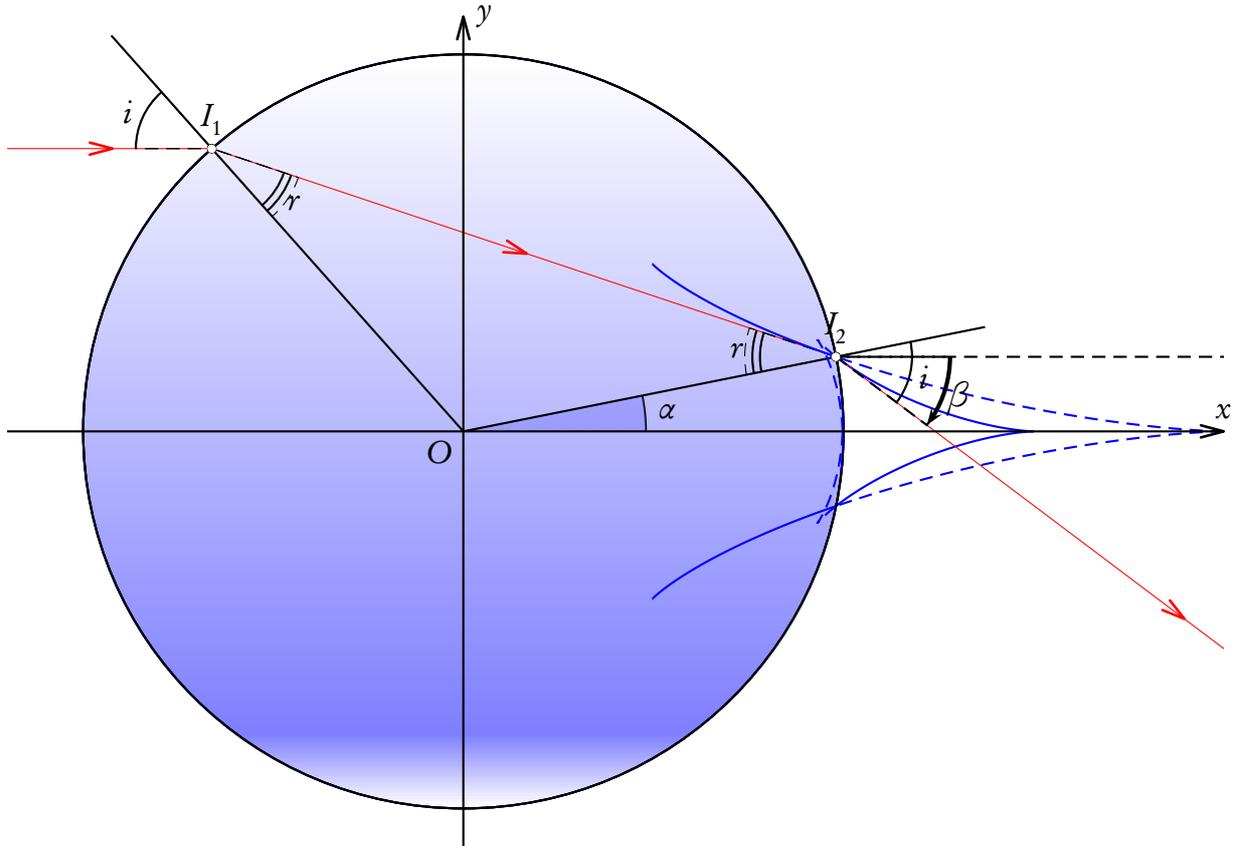
Pour déterminer l'équation du rayon émergent  $(\Delta)$ , nous avons besoin des coordonnées de  $I_1, I_2$ , des angles  $\alpha$  et  $\beta$ . Le paramètre que nous ferons varier est  $i, 0 \leq i < 90^\circ$ .
