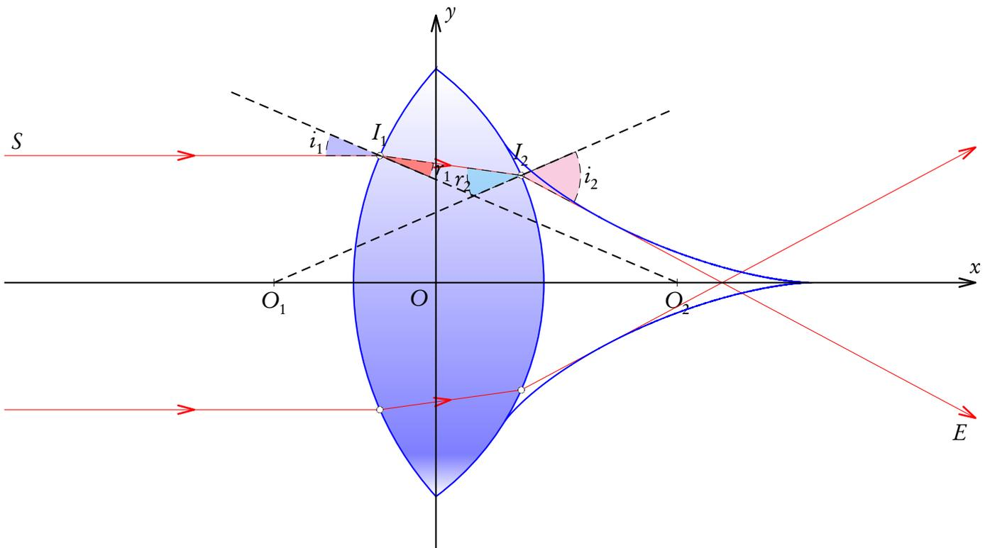
La lentille biconvexe est définie par les rayons  $R_1$  et  $R_2$  des deux faces ainsi que par la position du centre de la face 1 :  $x_{O_1} < 0$  (valeur qui doit être négative). La position du centre  $x_{O_2} > 0$  de la face 2 est calculé de façon à ce que l'axe  $Oy$  passe par l'intersection des deux cercles (sphères en 3 dimensions). Il est évident qu'il est nécessaire que  $|x_{O_1}| < R_1$ , en cas d'erreur sa valeur est fixée arbitrairement à  $x_{O_1} = -R_1 + 0,5$ .
